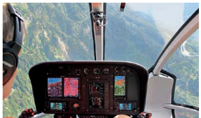
Testflug mit einem EC130 B4 nach einem Avionics-Upgrade mit neuem Garmin G500H.
