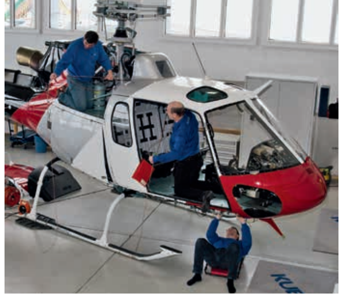
Für die Installation eines neuen TAS (Traffic Advisory System) werden neue Kabel verlegt und zusätzliche Antennen eingebaut.
