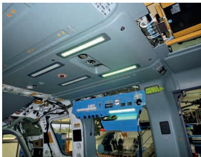
Die Deckenbeleuchtung des Kuerzi MMS-Systems in diesem EC145 T2 besteht aus zwei NVIS und zwei LED-Lampen. Mit dem Supply Panel über dem Fenster werden noch weitere Leuchtquellen eingebaut.
