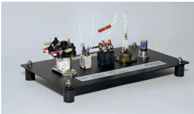
Der Teststand für das neue Produkt. Der Liquid Isolator schützt Kontakte und Ecken und Kanten.
