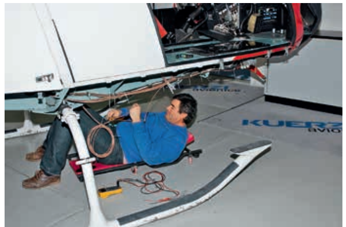
Hier arbeiten auch die Ingenieure am Fluggerät mit: René Zingre bei der Installation eines neuen Antennenkabels.
