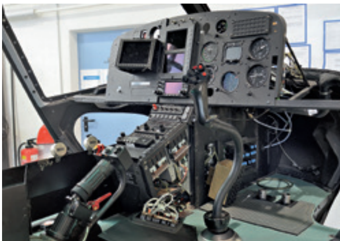
Modification de l'Avionique sur un AS350 B3.
