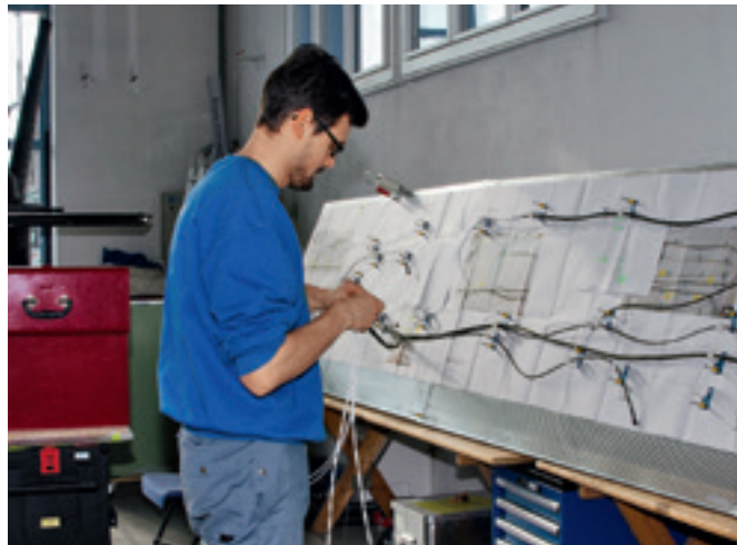
Nicolas Hütter prépare un faisceau de câbles de sorte à pouvoir le poser plus facilement dans le cadre de l'installation chez le client.
