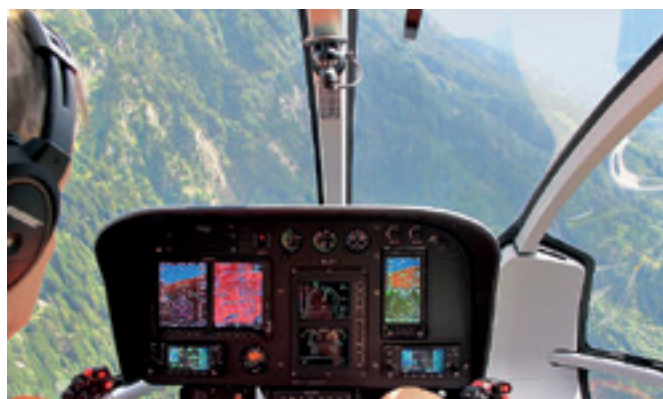
Vol d'essai d'un EC130 B4 au terme d'une mise à niveau de l'avionique avec le nouveau Garmin G500H.
