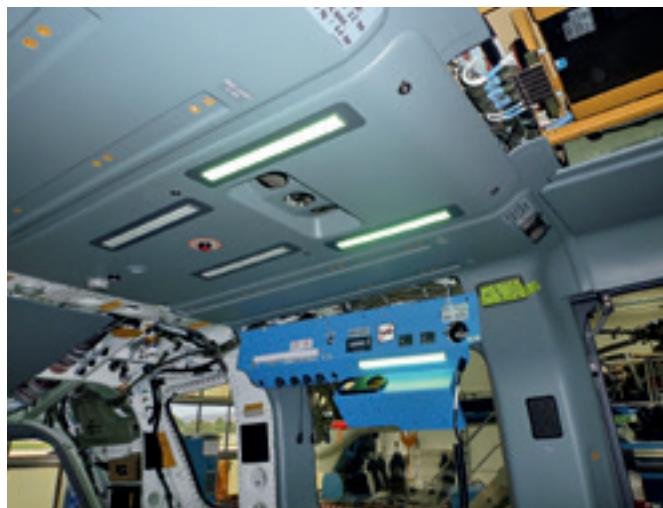
L'éclairage de plafond du système MMS Kuerzi dans cet EC145 T2 se compose de deux NVIS et de deux lampes à LED. Avec le Supply Panel au-dessus de la fenêtre, d'autres sources lumineuses seront encore incorporées.
