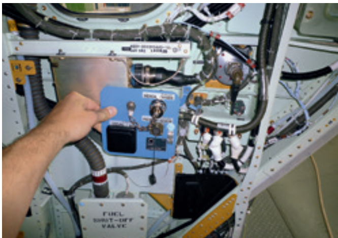
Le Panel d'oxygène avec KPH100 AC Outlet Control et Power Outlets sera installé sous la fenêtre arrière dans un EC145 T2.
