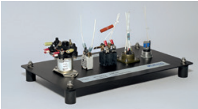
L'épreuve de test pour le nouveau produit. L'isolateur liquide protège les contacts, les angles et les rebords.
