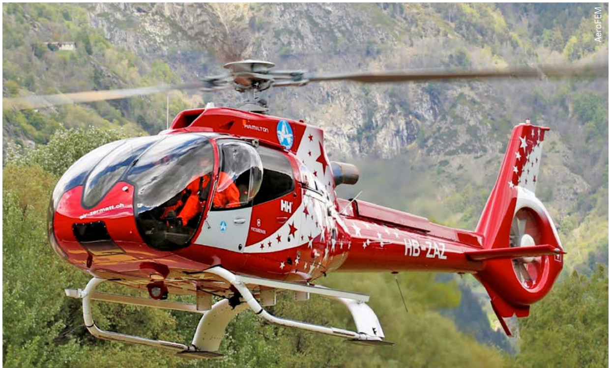
Flugerprobung des H130 T2 Bubble Windows
