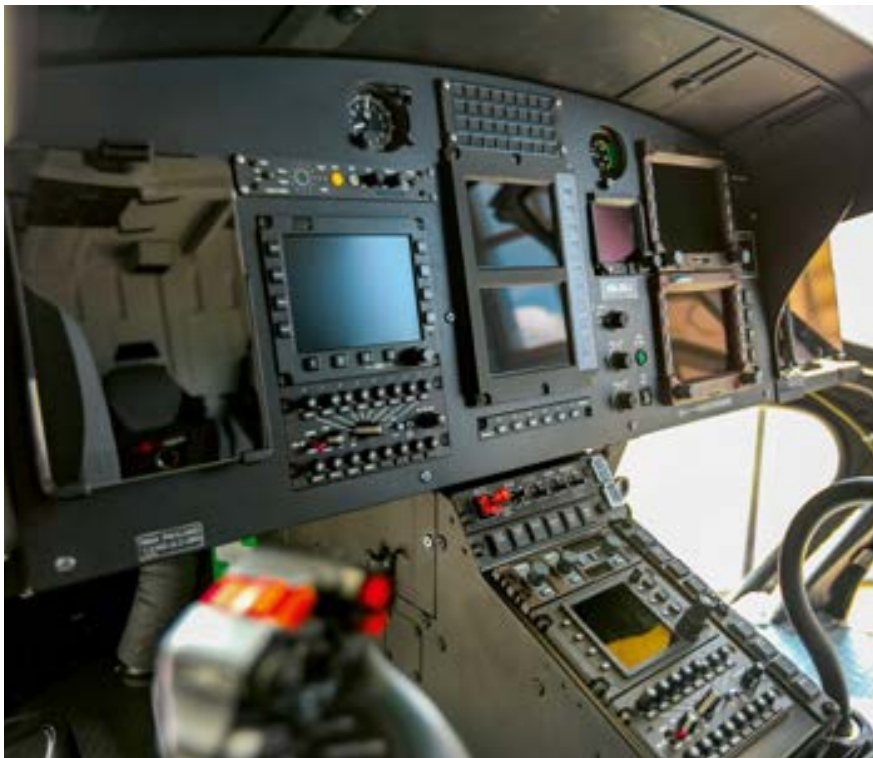
Das Cockpit des Rega H125-Ecureuil-Schulungshelikopter hat Kuerzi Avionics auf den AW109-Standard umgebaut.
